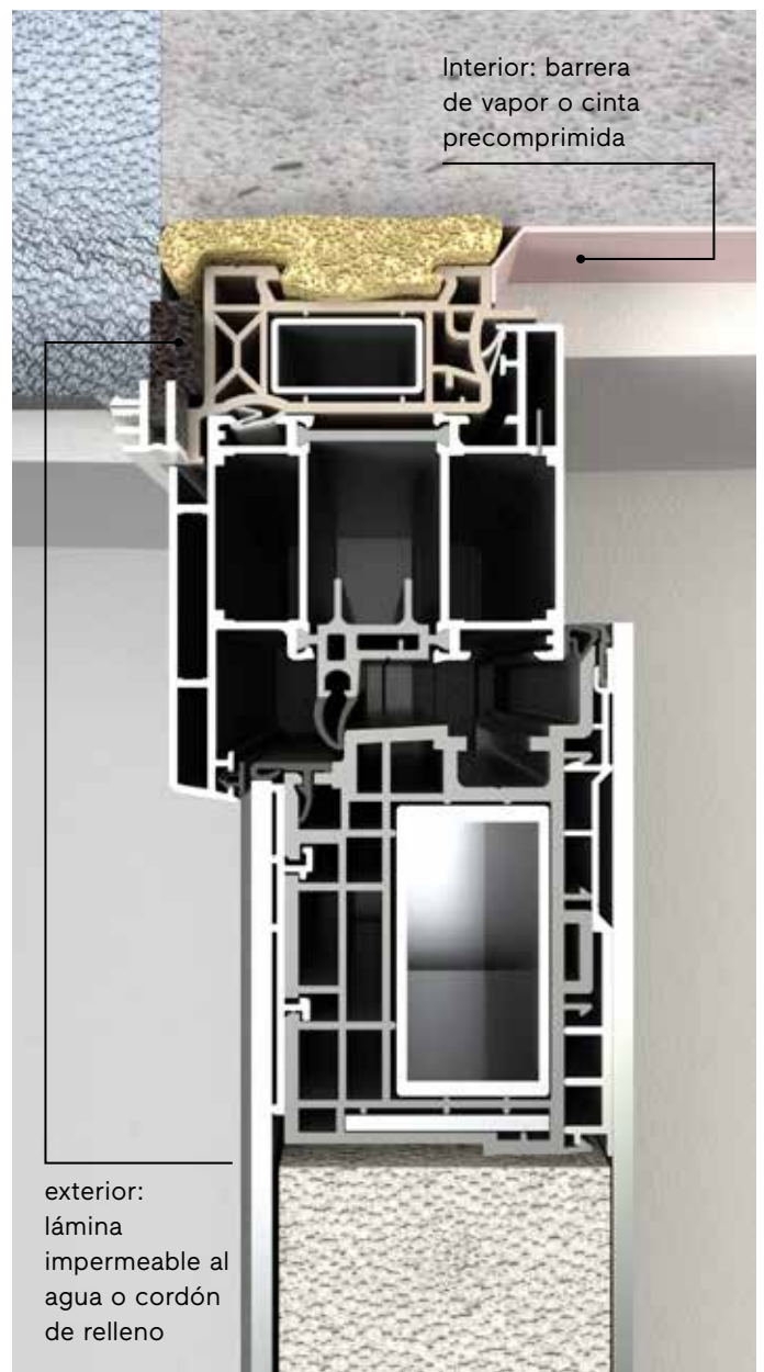
Montaje con premarco en dos fases
