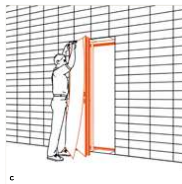
Protección con lonas y plásticos del marco y de la hoja.
