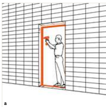
Fijación del nuevo marco al muro en fase de construcción.
