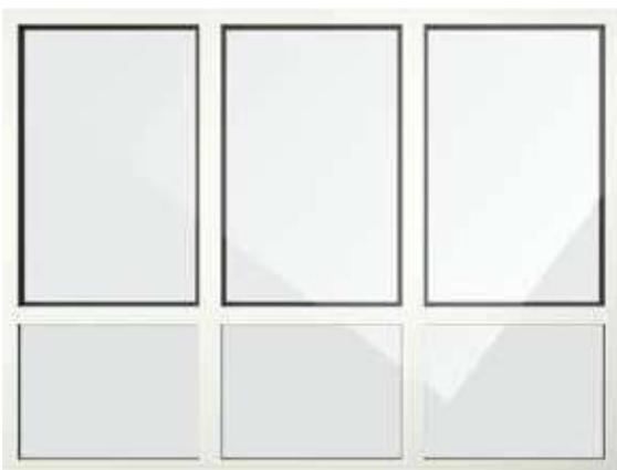
Combinación de seis ventanas, tres con hoja oculta y tres fijos inferiores
